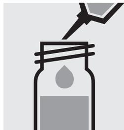
Pipetter **prudemment** 5,0 ml d'**échantillon appauvri** dans un tube à essai, fermer hermétiquement avec le bouchon fileté et mélanger vigoureusement. **Attention, le tube devient brûlant.**
