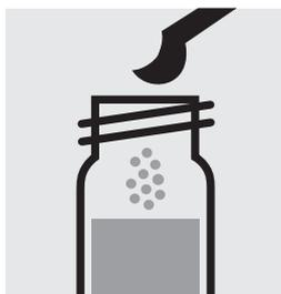
Verser 1 microcuiller jaune arasée de  $\text{NO}_3\text{-1K}$  dans un tube à essai, fermer avec le bouchon fileté.
