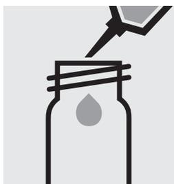
Pipetter 4,0 ml de **AC-1** dans un tube.
