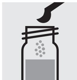
Ajouter 1 microcuiller jaune arasée de **N-3K** dans un tube à essai, fermer avec le bouchon fileté.
