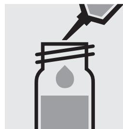
Pipetter 5,0 ml d'**échantillon préparé**, fermer avec le bouchon fileté et mélanger.
