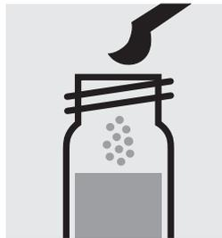
Ajouter 1 microcuiller bleue arasée de  $\text{Cl}_2-1$ , fermer avec le bouchon fileté.
