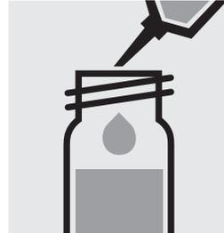
Ajouter 0,20 ml de **Cd-1K** à la pipette, fermer avec le bouchon fileté et mélanger.
