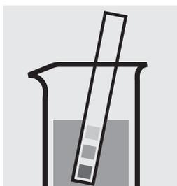
Vérifier le pH de l'échantillon. Domaine nécessaire: pH 4 – 8. Si nécessaire, ajuster le pH en ajoutant goutte à goutte du sodium hydroxyde en solution diluée ou de l'acide sulfurique dilué.
