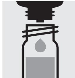
Ajouter 3 gouttes de **CN-2K**, fermer avec le bouchon fileté et mélanger: **échantillon préparé**.
