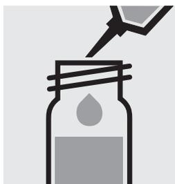
Pipetter 3,0 ml d'échantillon préparé par agitation dans un tube à essai.
