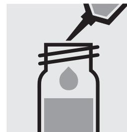
Ajouter 0,25 ml de **Al-2K** à la pipette, fermer avec le bouchon fileté et mélanger.
