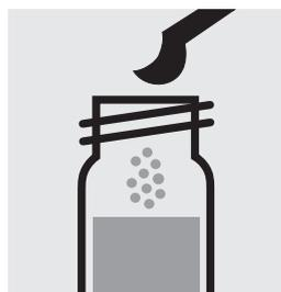
Ajouter 1 microcuiller grise de **TOC-2K**. Boucher **immédiatement** et hermétiquement le tube avec le bouchon en aluminium (art. 173500).
