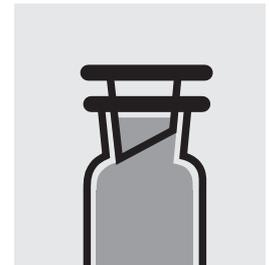
Incuber à 20 ± 1 °C pendant 5 jours dans une armoire thermostatique hermétiquement bouchés 1 flacon d'**échantillon préparé** et 1 de **solution de sels nutritifs inoculée**.
