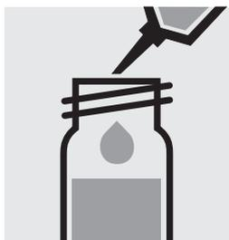
Pipetter 1,0 ml d'échantillon dans un tube à essai, **ne pas mélanger**.
