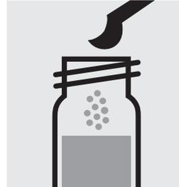
Ajouter 1 microcuiller bleue arasée de **CN-3K**, fermer avec le bouchon fileté.
