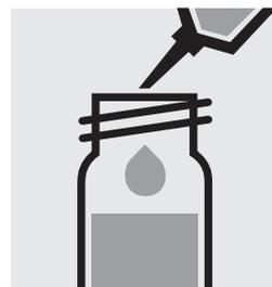
Ajouter 2,0 ml d'échantillon à la pipette, fermer avec le bouchon fileté et mélanger. **Attention, le tube devient brûlant.**
