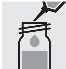
Pipetter **prudemment** 3,0 ml d'**échantillon à blanc appauvri** dans un deuxième tube à essai, fermer hermétiquement avec le bouchon fileté et mélanger vigoureusement. **Attention, le tube devient brûlant.**
