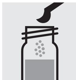
Ajouter 2 microcuillères vertes arsées **AOX-6**, fermer le tube avec le bouchon fileté et mélanger.
