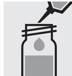
Ajouter 5,0 ml de **OA-5** à la pipette, fermer avec le bouchon fileté et agiter vigoureusement.
